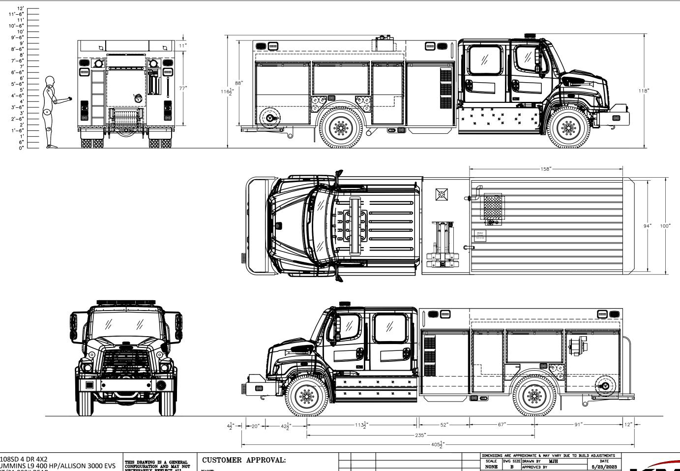
CAB: FREIGHTLINER 108SD 4 DR 4X2 ENGINE & TRANS: CUMMINS L9 400 HP/ALLISON 3000 EVS AXLES: 12,000# FRONT/31,000# REAR PUMP: HALE QMAX-150 1500 GPM SINGLE STAGE PUMP
